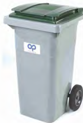
Contenedor de 2 ruedas Contenedores fabricados en polietileno de alta densidad por inyección, lo que permite fabricar el cuerpo en una sola pieza. Tapa ligera y flexible. Paredes interiores totalmente lisas para facilitar la limpieza. También disponible con pedal. Capacidad 90, 120, 240 y 360 lts.
